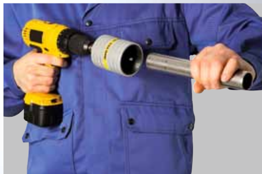
Antrieb durch handelsüblichen Schrauber.
